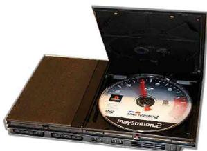
**Для PStwo:** когда диск установлен правильно ВСЕ зажимы должны быть сверху диска, иначе диск будет вращаться неровно и повредит оптическую головку и двигатель.
